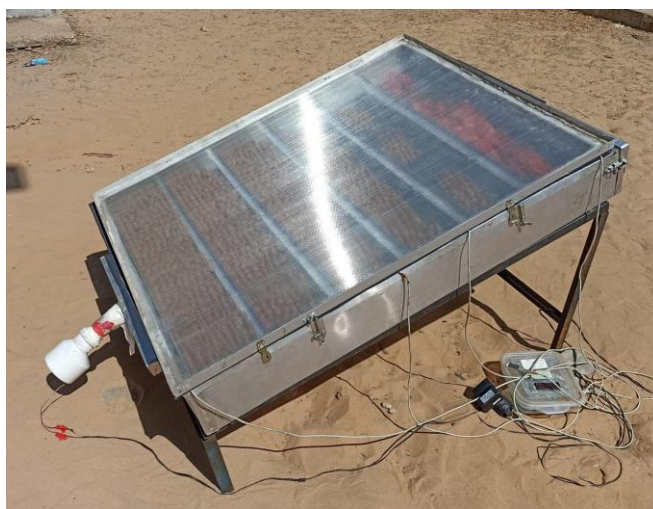
Figura 1: Secador solar de exposição direta. Fonte: Os autores (2024).
