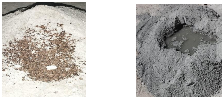
a) Seixo, areia e farelo do caroço do açaí. b) Mistura (a) + cimento e água.
