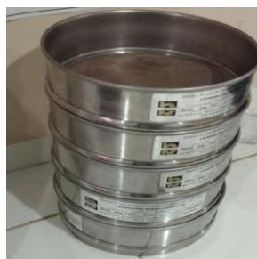
Figura 4: Passo 5 - Peneiramento nas Malhas nº 4, 2, 1 e 0,25 mm.
