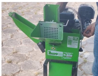
Figura 3: Passo 4 - Trituração utilizando uma faca de corte com abertura de 12mm.
