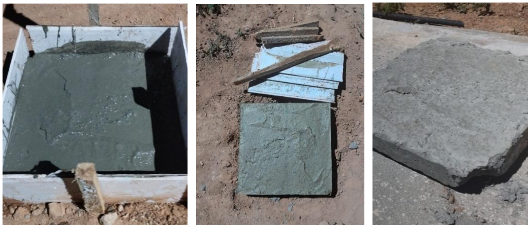
Figura 25: Concretagem da placa cimentícia em uma forma com medidas de 30 cm x 30 cm.
