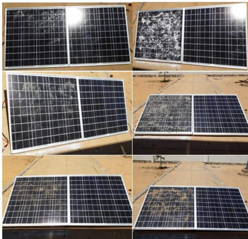
Figura 2: Arranjo experimental com a primeira e a última deposição do gesso, do cimento e da areia com os módulos inclinados a 25^\circ .
