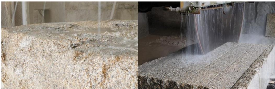
Figura 2: Diferença entre o corte com fio de diamante e o corte com serra
