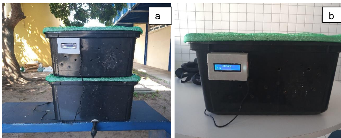
Figura 4: (a) Composteira inteligente montada (caixa superior com os furos para entrada de ar e a caixa base para recolhimento do líquido da parte superior e torneira de esvaziamento) e (b) painel mostrando a leitura dos sensores de umidade e temperatura.
