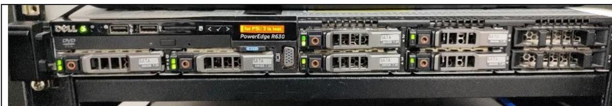
(A) Servidores físicos *Dell PowerEdge R630* instalados no rack da sala de T.I. - Campus IFAM - Itacoatiara (AM).
